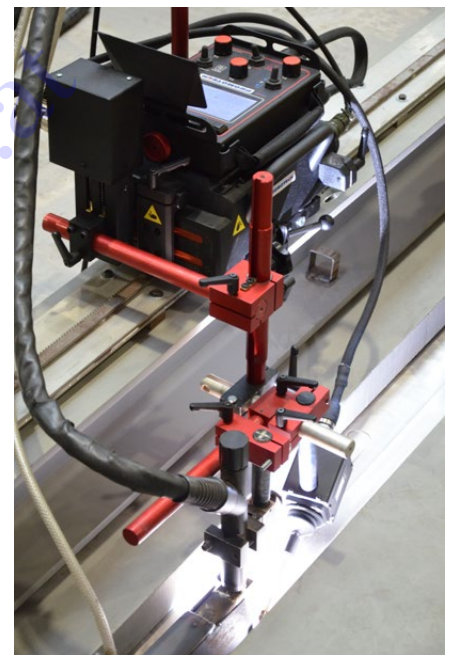
Nahtführung funktioniert mit und ohne Oszillation
