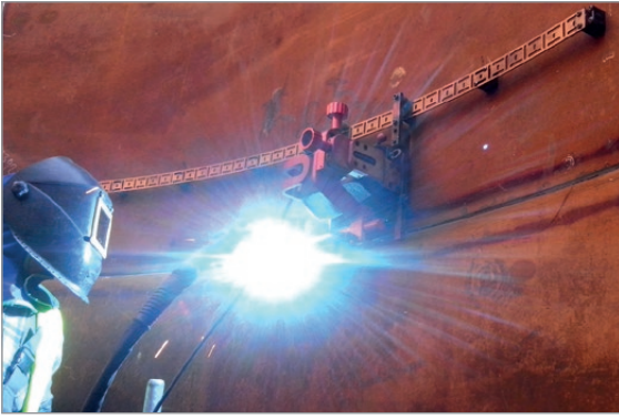
Lange flexible Schiene 185 cm 1 St. Minimaler Krümmungsradius von 1,0 m PRW-0466-50-01-0-0
