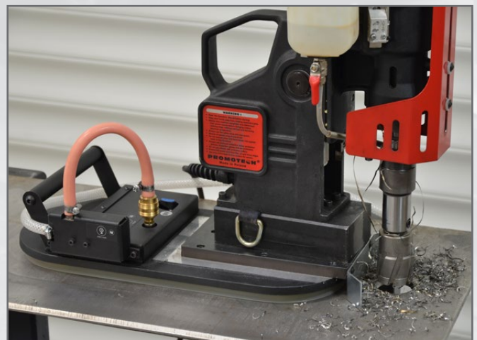
DRUCKLUFTVERSORGUNG (optionale Konfiguration)
