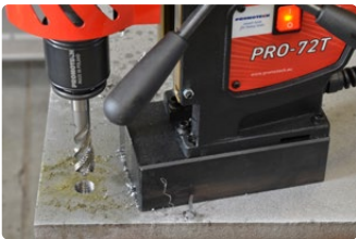
Gewindeschneiden von Durchgangsbohrungen bis M20
