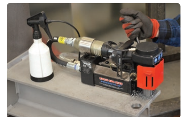
Kühlsystem durch die Spindel
