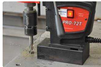
Gewindeschneiden von Sacklöchern bis M20
