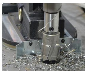
Kernbohrer 50 mm Verlängerung Produktcode: PRD-000004 Erfordert einen Führungszapfen (siehe Tabelle)
