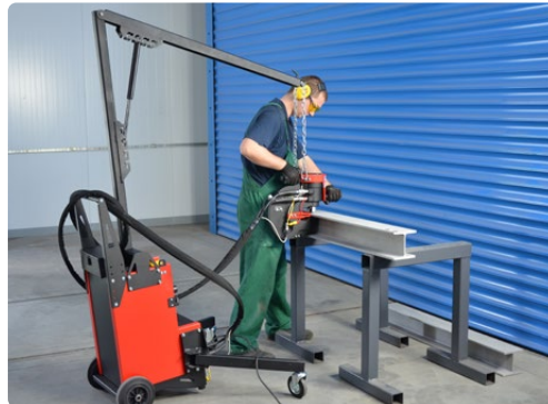
Schlaucharm und 2 Träger mit Rädern erlauben einen einfachen Einsatz von Stanzer und Hydraulikstation als eine Einheit.
