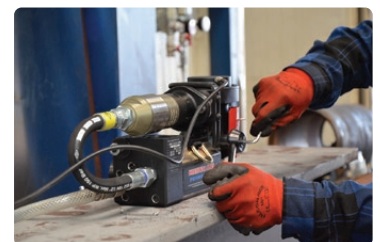
Der Vorschubhebel kann von beiden Seiten fixiert werden
