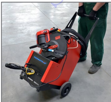
tragbare Hydraulikstation mit Ablage zum Transport der Lochstanze
