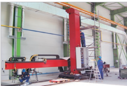
Montage und Inbetriebnahme des Kreuzmasts am Kundenstandort.
