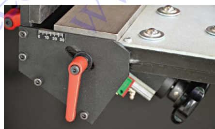
Einfache Einstellung der Fasenbreite
