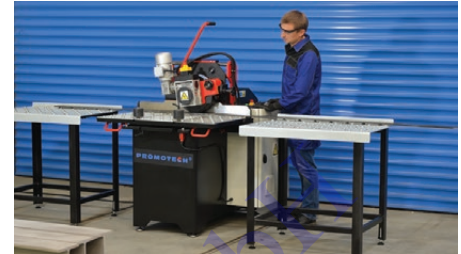
Hilfstische für lange Werkstücke
