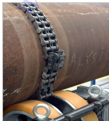
Einstellbare Kette (ø 200-1000 mm) sorgt für positive axiale Drehung
