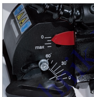
Kontinuierliche Winkeleinstellung von 0 bis 60 Grad.
