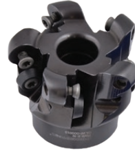
GLW-000015 Fräskopf J-Fase R8 (5 Wendeschneidplatten R8 erforderlich)
