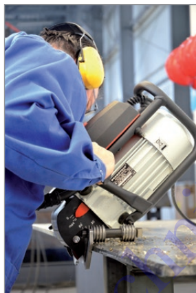
Fasen von Blechen
