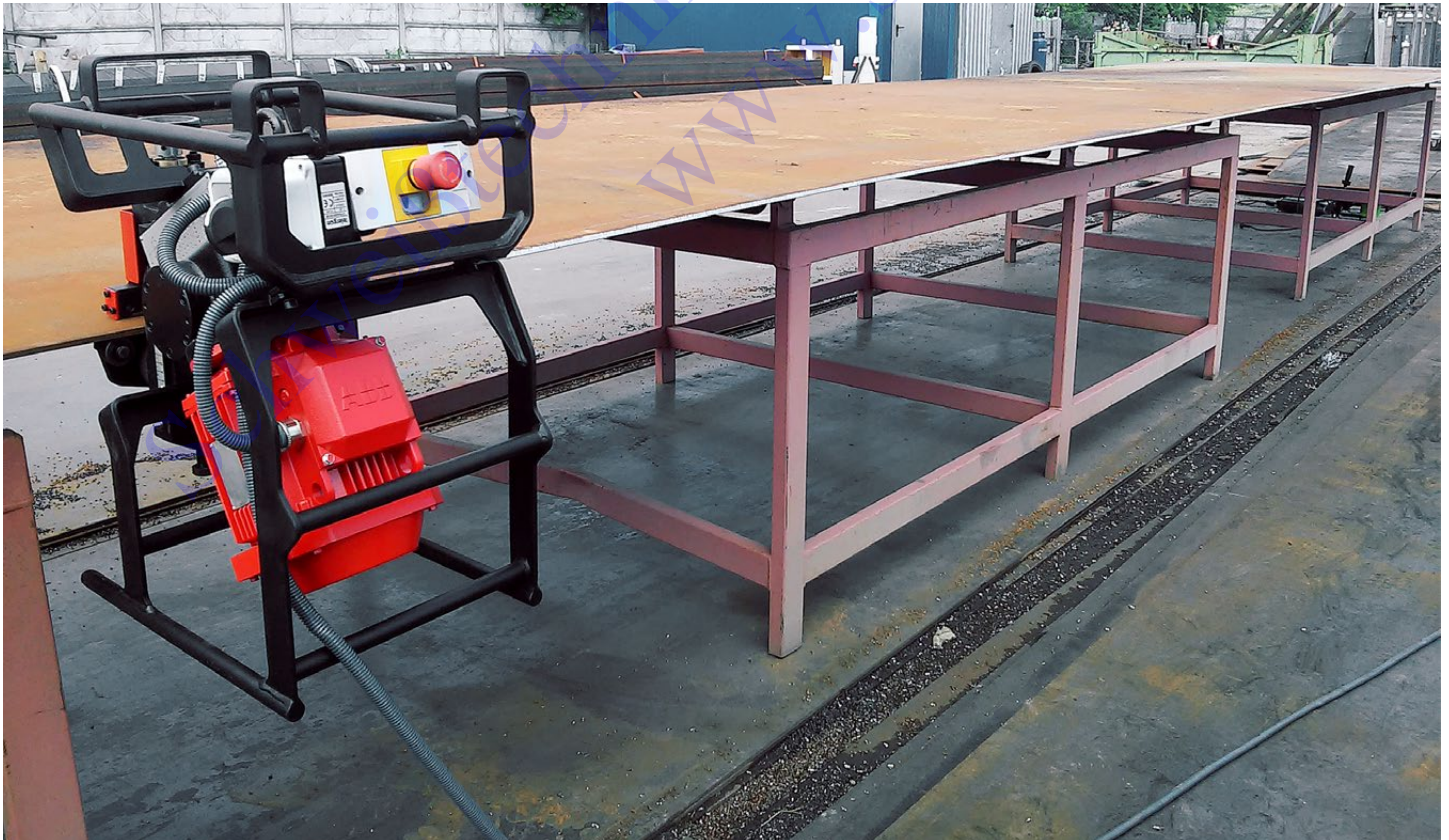
ABM-14 läuft automatisch an der Platte entlang
