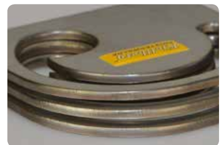
3 mm Edelstahl geschnitten mit HiFinox | 3 mm stainless steel cut with HiFinox
